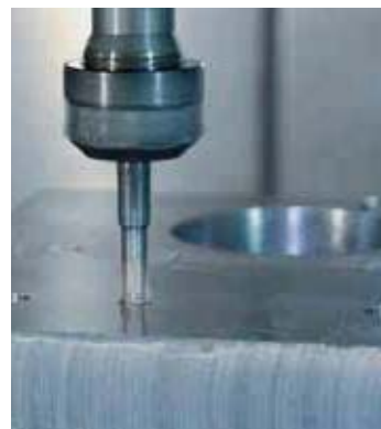
MQL 2채널 시스템을 이용한 탭핑 작업
