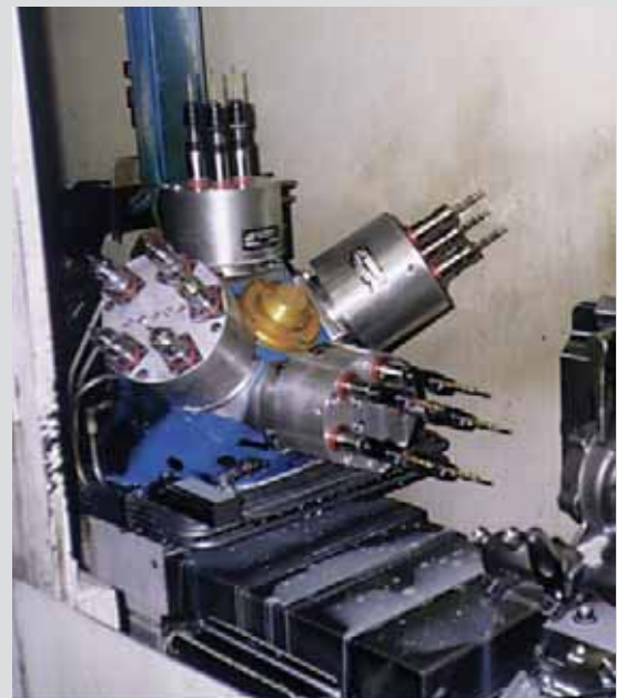
Augmentation du couple par réducteur de vitesse Erhöhung des Drehmoments durch Untersetzungs spindel High torque with speed reduction unit
